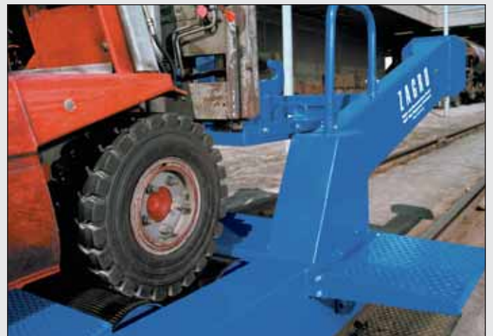
Antriebsrollen zur Kraftübertragung
