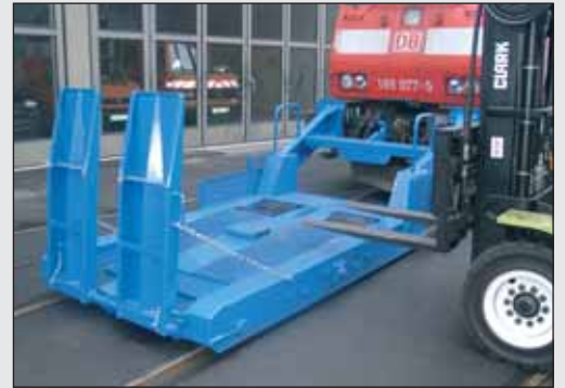
Absetzen auf der Schiene im niveaubebenen Bereich
