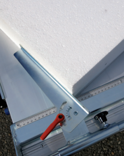
Gehrungswinkel-Anschlag Mitre square stop for bevel cuts
