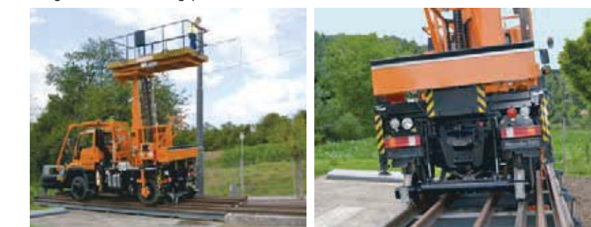
Testgleis mit Überhöhungsprüfstand / Cant test track
